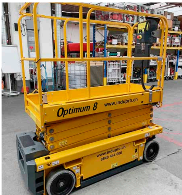
Elektro-Scherenarbeitsbühne für Unterhaltsarbeiten
